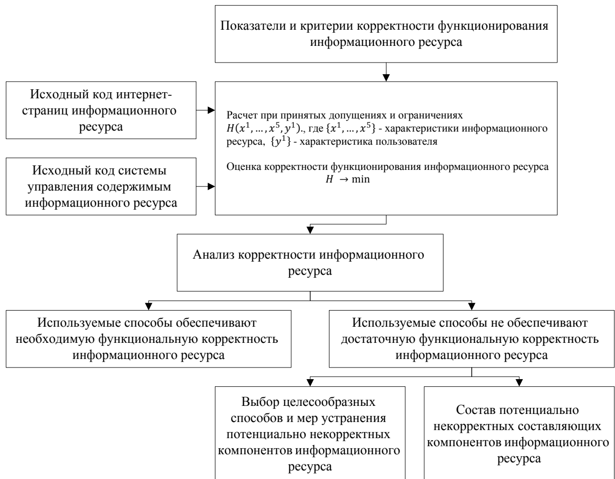
Рис. 4. Структура методического аппарата для проведения оценки корректности функционирования информационного ресурса
