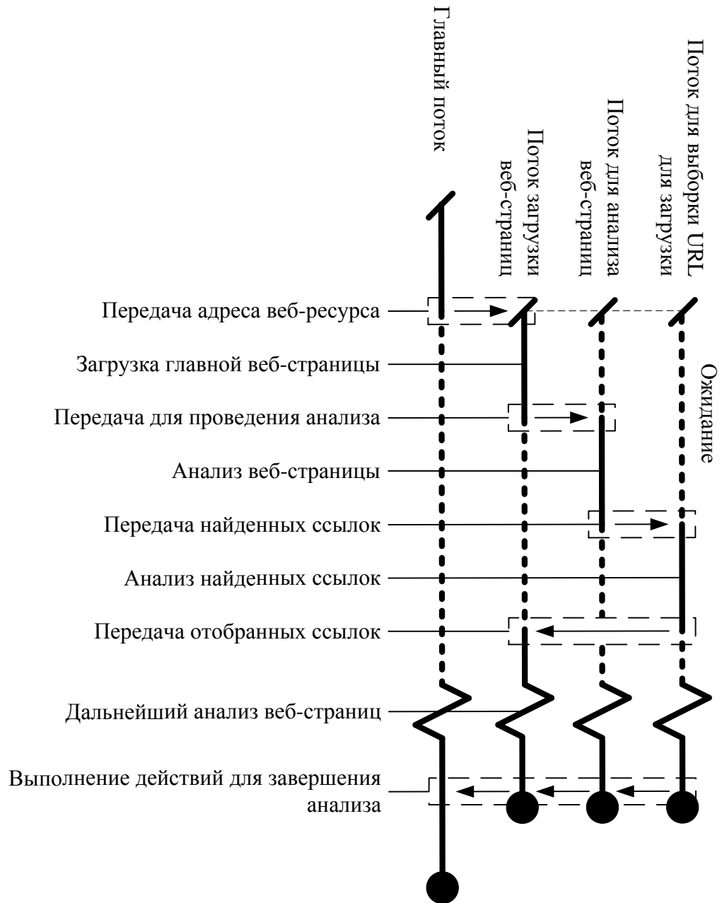
Рис. 20. Предложенный вариант многопоточной реализации
