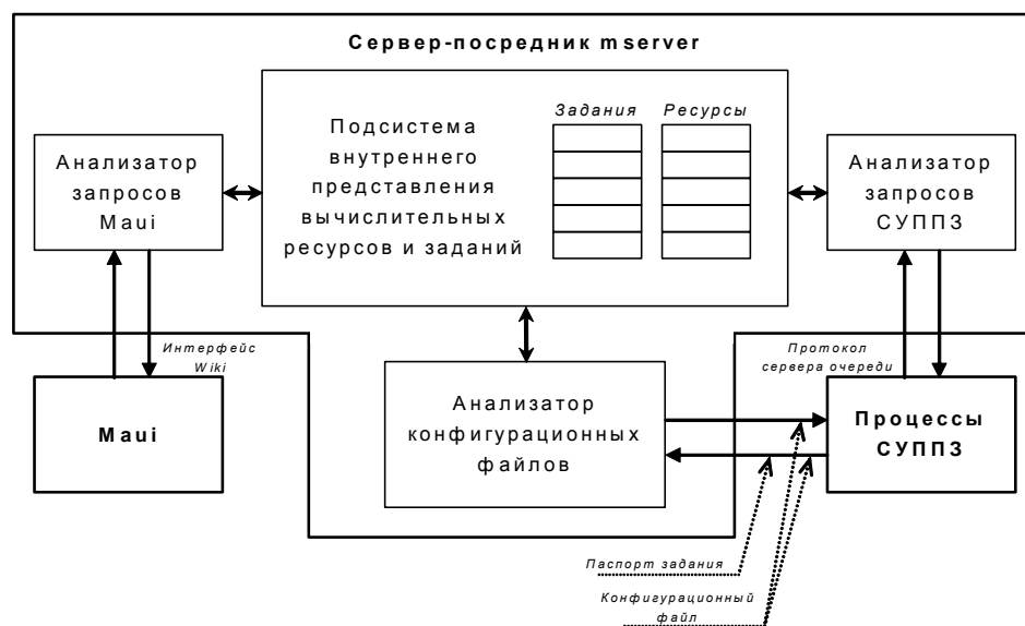
Рисунок 12. Структура сервера-посредника для интеграции планировщика Maui в состав СУППЗ
