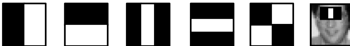
Рисунок 1 — Признаки Хаара и пример расположение признака относительно сканирующего окна
