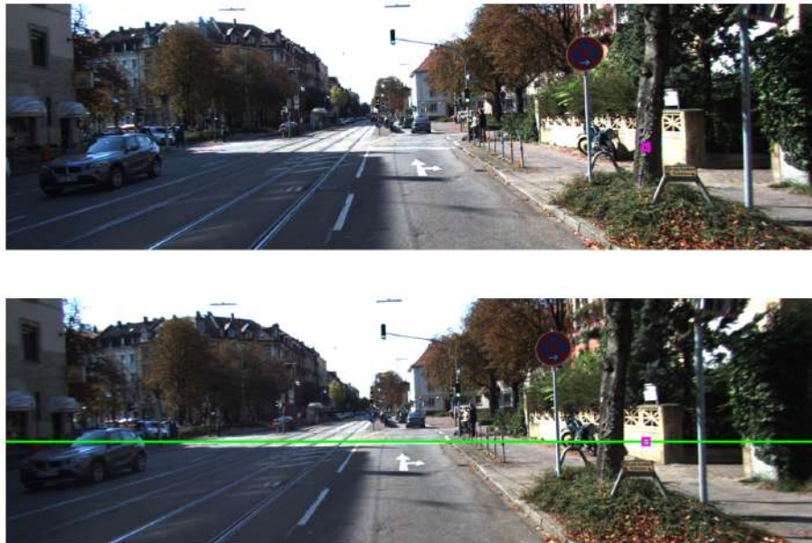
Рис. 3.4: Иллюстрация алгоритма поиска одномерного поля смещений. На рисунке сверху представлено левое изображение I_l , фрагмент для которого производится поиск соответствия выделен фиолетовым цветом. Правое изображение I_r показано на рисунке снизу: линия, по которой ведется поиск соответствия, выделена зеленым.
