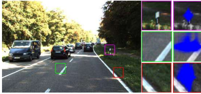
Рис. 3.15: Пример сглаживания с применением рекурсивного фильтра. Каждый из трех фрагментов справа, обозначенных разными цветами, показывает относительный вклад центрального пиксела в интенсивности остальных пикселей фрагмента. Центральный пиксел первого фрагмента соответствует дорожному столбу (процесс сглаживания ограничен границами столба ввиду перепада диспаритета). Фрагменты, обозначенные зеленым и красным цветом, являются примерами отток или границ дорожной поверхности, релевантных (красный цвет) или нерелевантных (зеленый цвет) перепадам диспаритета.
