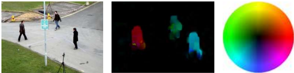
Рис. 2.4: Пример вычисления оптического потока для кадра видеопоследовательности из публичной коллекции изображений [20]. Эталонный кадр показан на рисунке слева, поле смещений представлено на рисунке посередине, цветовая схема для кодирования двумерных векторов смещения представлена на рисунке справа.
