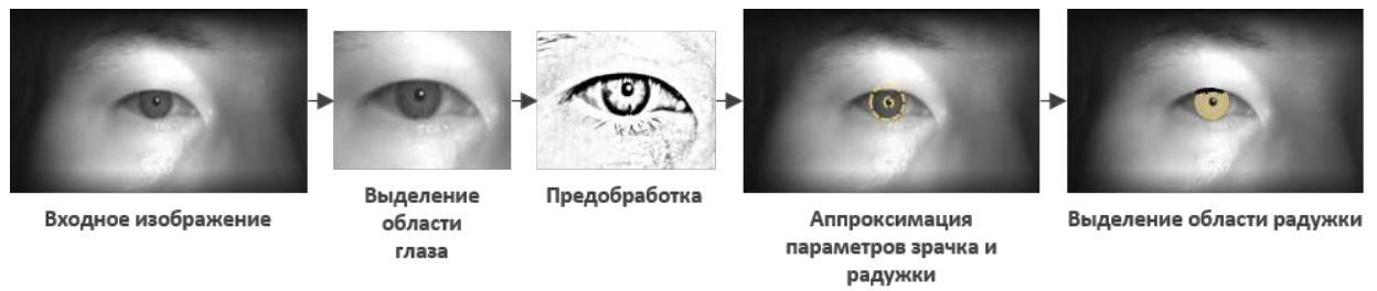
Рис. 4.2. Обобщенная последовательность шагов классических методов сегментации изображения радужки.
