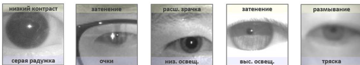
Рис. 4.1. Примеры растров области глаза, извлекаемых в мобильной системе распознавания: причина (снизу) и результат (сверху)
