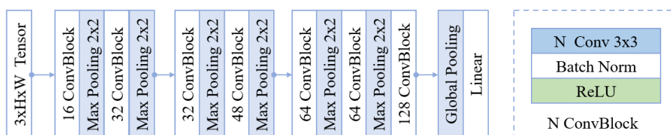
Рис. 2.11. Строение нейронной сети BaseNet.
