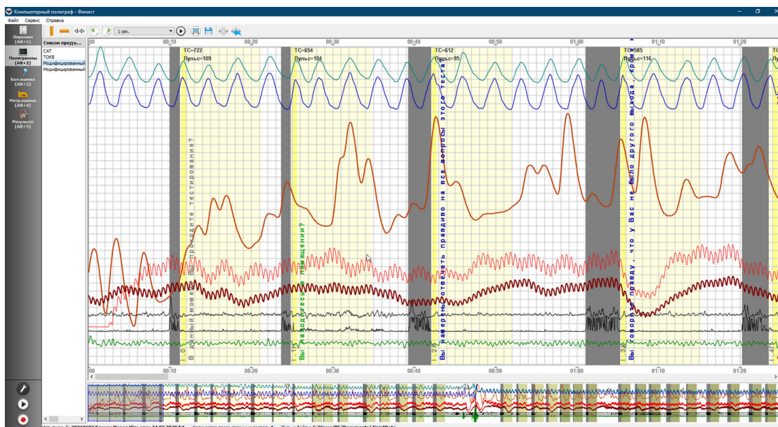
Рис. 3.1. Скриншот полиграммы в интерфейсе профессионального компьютерного полиграфа «Финист». Каналы съема психофизиологических характеристик отмечены следующими цветами: грудно дыхание - синий, диафрагмально дыхание - бирюзовый, кожно-гальваническая реакция - коричневый, пьезоплетизмограмма - бордовый, фотоплетизмограмма - красный, тремор - зеленый цвет
