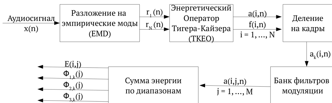
Рис. 1.6. Схема вычисления спектральных признаков модуляции (MS).
