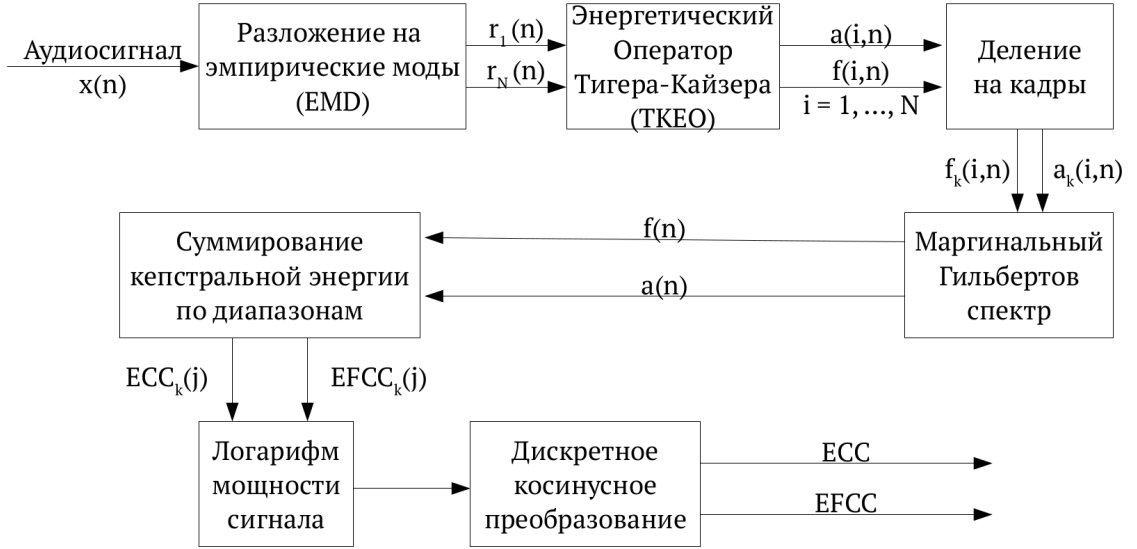
Рис. 1.5. Схема вычисления кепстральных коэффициентов энергии (ЕСС) и частотно-взвешенных кепстральных коэффициентов энергии (ЕFСС).
