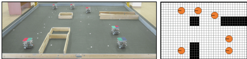
Рис. 8 — Внешний вид полигона во время проведения экспериментов с группировкой из 6 роботов – слева. Справа – соответствующий ГРД.
